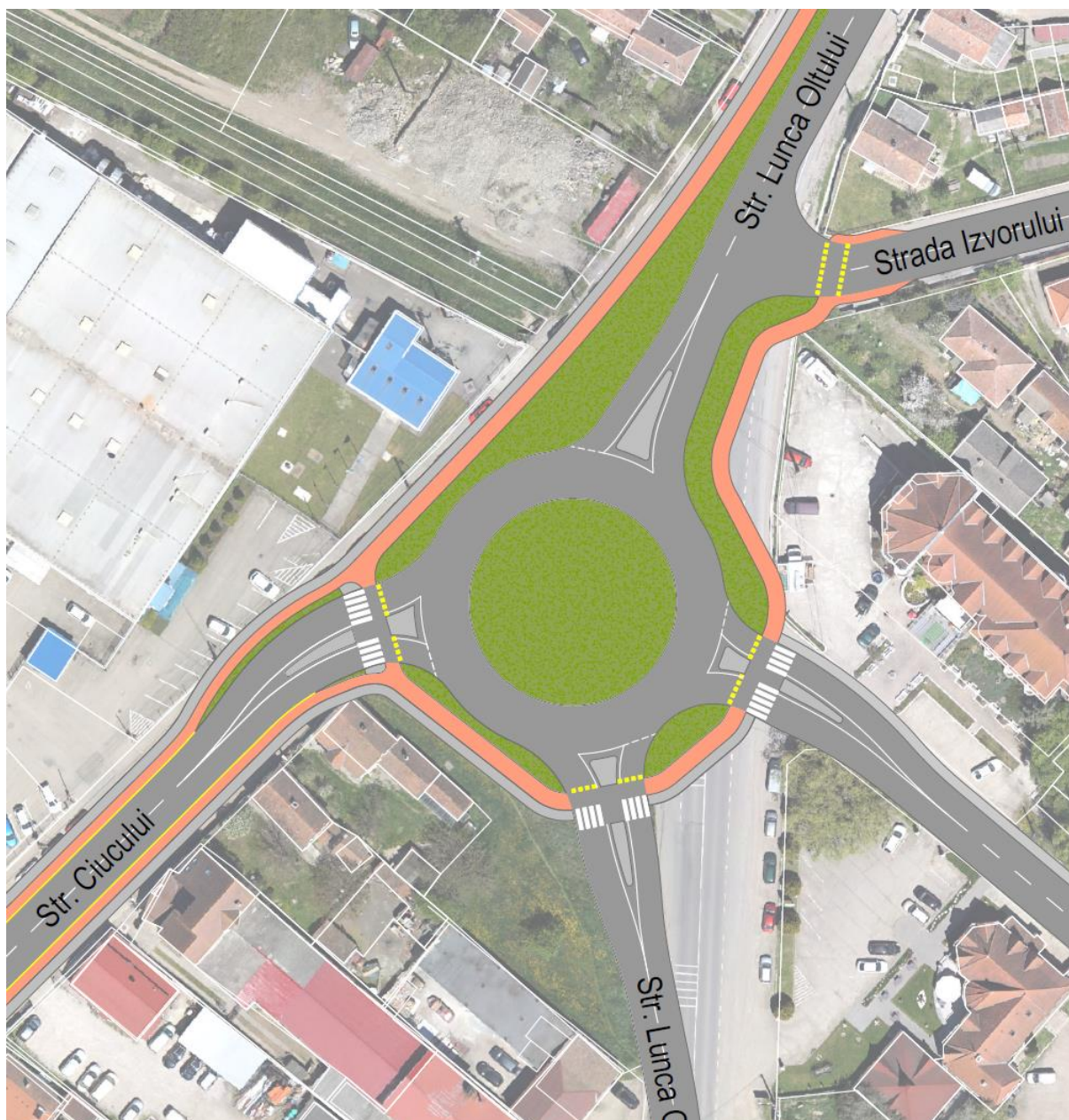
Proiectul propus pentru intersecția străzilor Lunca Oltului și Ciucului (diagramă conceptuală)
