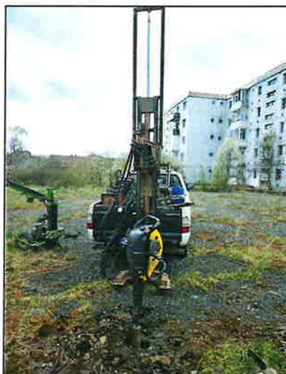
Foto 2. Aspectul terenului investigat cu instalația de foraj geotehnic utilizat
