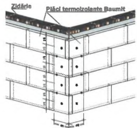
Fig. 13 Dispunerea plăcilor în câmp și la colțuri
