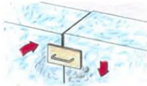
Fig. 14 Șlefuirea zonei de îmbinare între plăci
