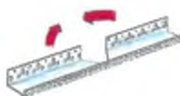
Fig. 3 Pentru zonele de cap se recomandă folosirea profililor speciali
