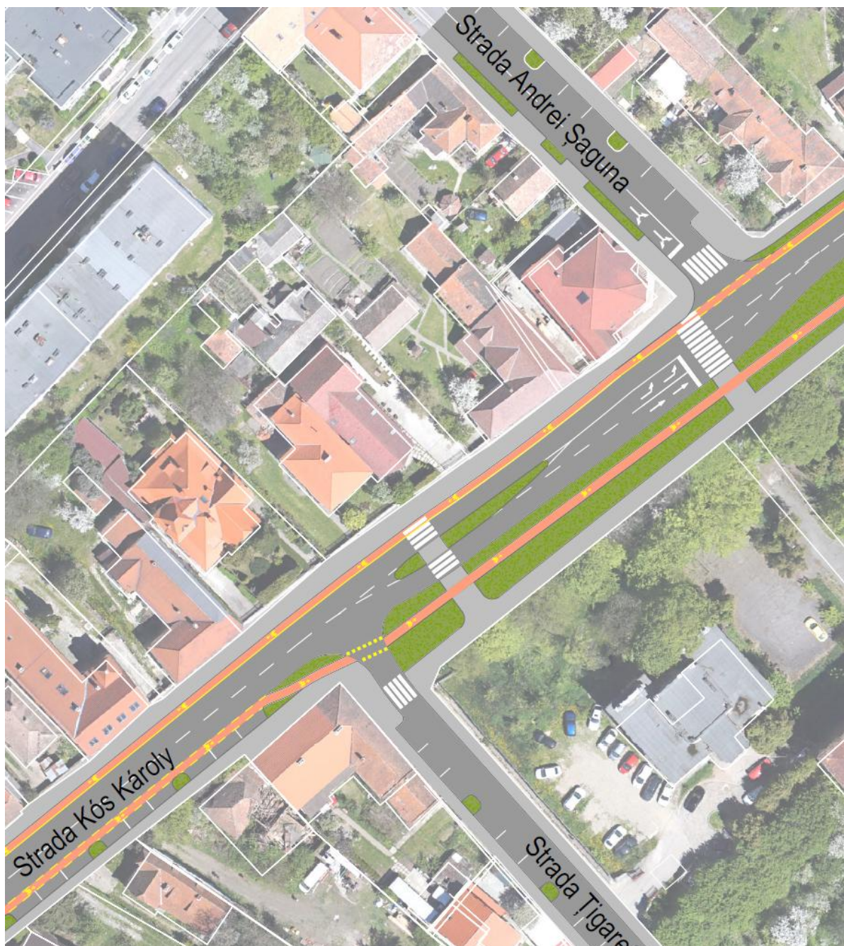
Proiectarea propusă a intersecției străzilor Kós Károly și Andrei Șaguna și intersecția de pe strada Țigaretei (diagramă conceptuală)
