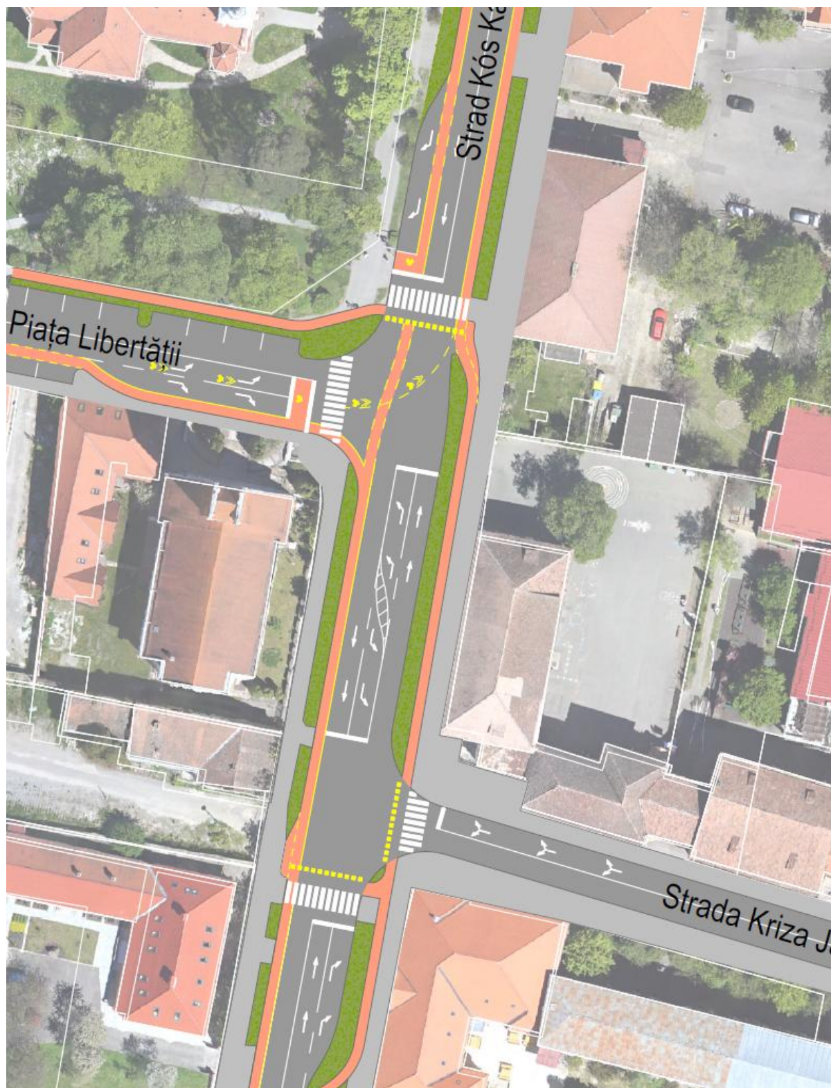
Proiectarea propusă a tronsonului dintre intersecția străzilor Kós Károly și Kriza János și intersecția de pe strada Spitalului (diagramă conceptuală)
