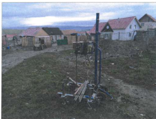
Foto 2.: Aspectul terenului investigat și instalația de sondă de penetrare PDM utilizat.
