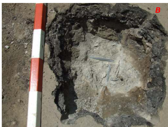
Sondaje de verificare a continuității stratului de beton din zona sondajului S 2
