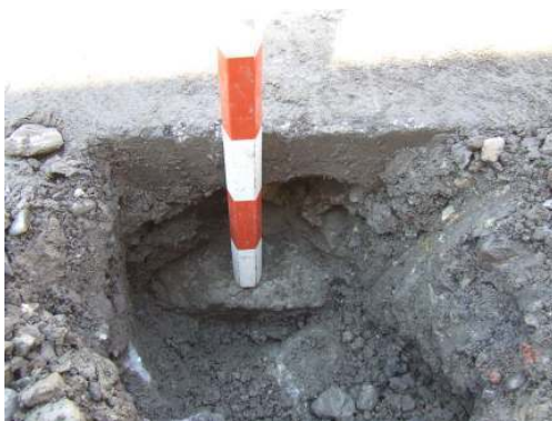
Sondaj de verificare a stratului de beton sub asfalt în zona sondajului nr. 4
